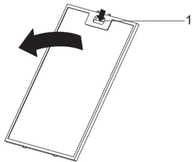
Не устанавливайте фильтр в вытяжку до его полного высыхания. Установка фильтра производится в обратном порядке. Следует нажать на пружинный замок на фильтре и установить его на место, после чего замок отпустить.
