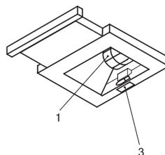
Микровыключатель создает дополнительные удобства при пользовании вытяжкой. При перемещении выдвижной панели в крайнее переднее положение он включает вытяжку на ранее установленной Вами скорости вентиляции. При возвращении выдвижной панели в исходное состояние он выключает вытяжку.
